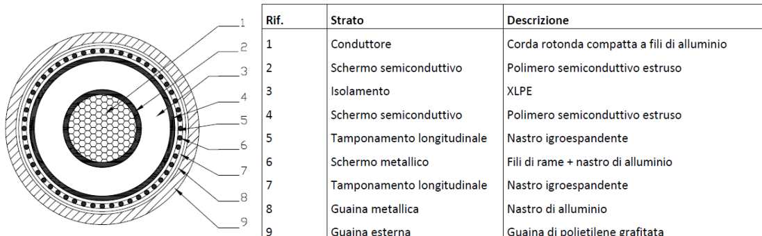
Figura 5 Schema tipico del cavo AT
