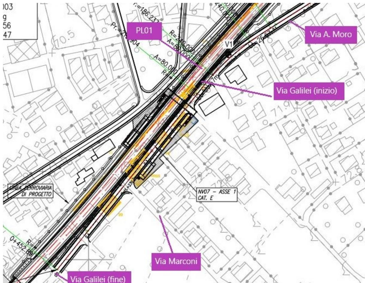
Figura 22 - Viabilità di progetto Via Galilei
