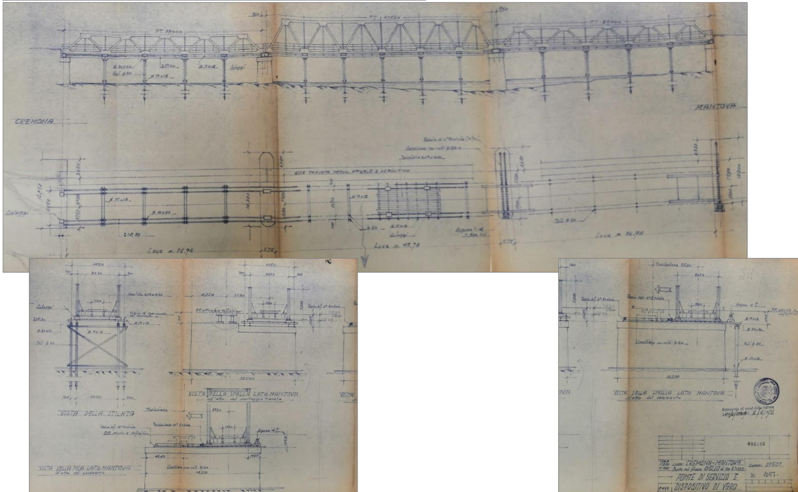
Figura 22 – Stralci elaborato grafico con indicazione dispositivi di varo e schema di traslazione delle travate (da archivio Fondazione FS)
