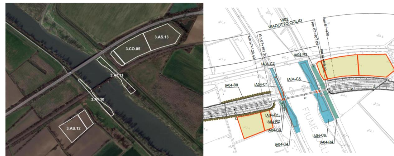
Figura 4-10 Aree di cantiere 3.AT.10, 3.AT.11, e aree di cantiere limitrofe. Confronto con il progetto delle opere a verde previste al termine della cantierizzazione
