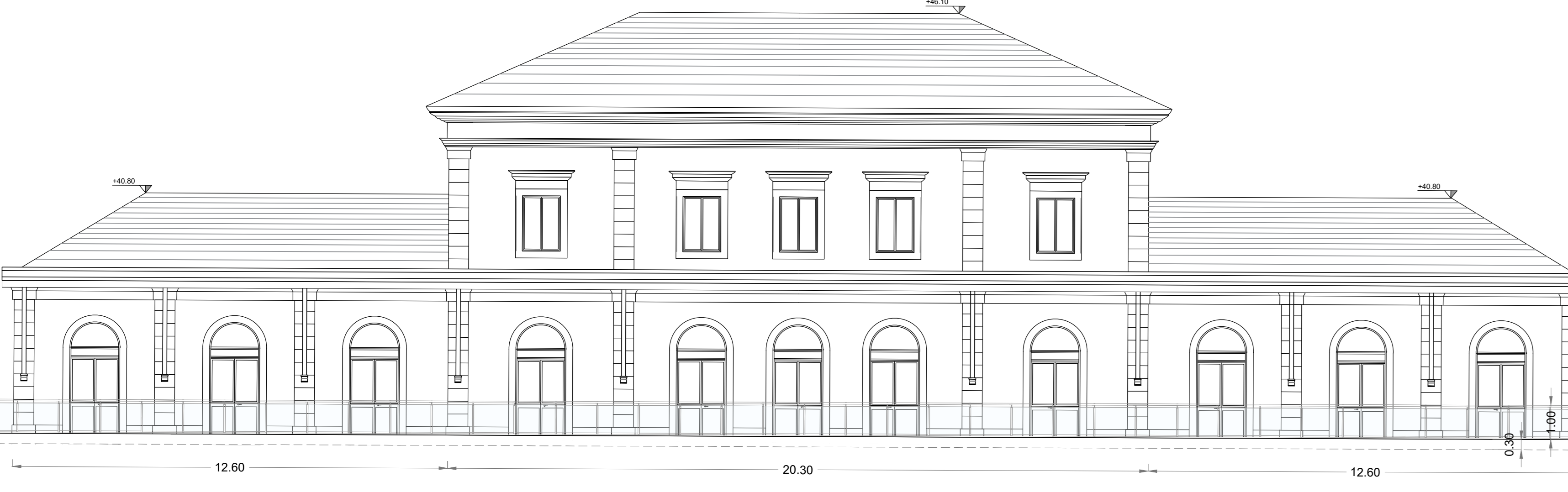
PROSPETTO FV LATO BINARI - POST OPERAM scala 1:100
