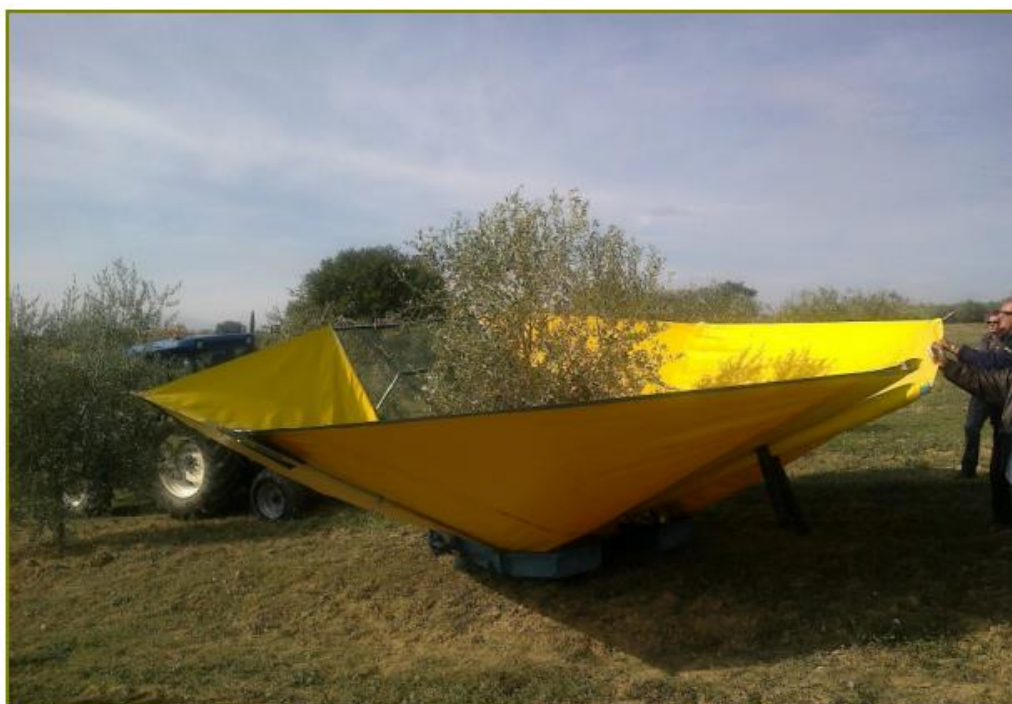
Figura 33 - Raccolta meccanizzata con braccio vibratore e telaio intercettatore ad ombrello rovesciato.
