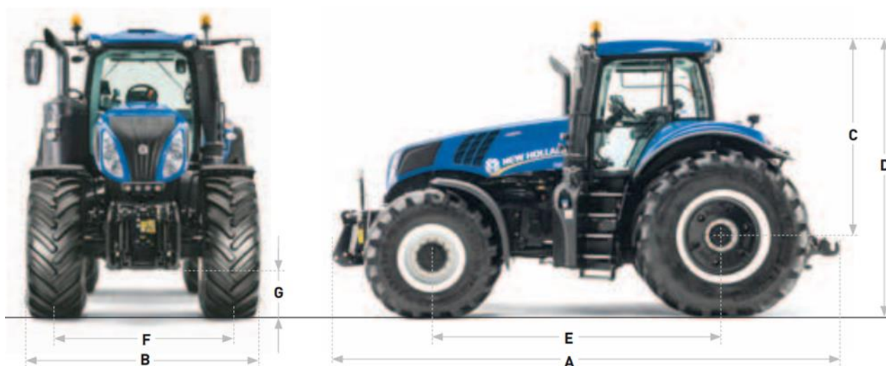
Figura 47 - Dimensioni del più grande dei trattori gommati convenzionali prodotti dalla NEW HOLLAND
