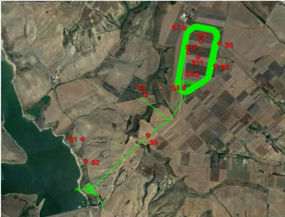
Figura 7.2: Ubicazione Sondaggi Geognostici
