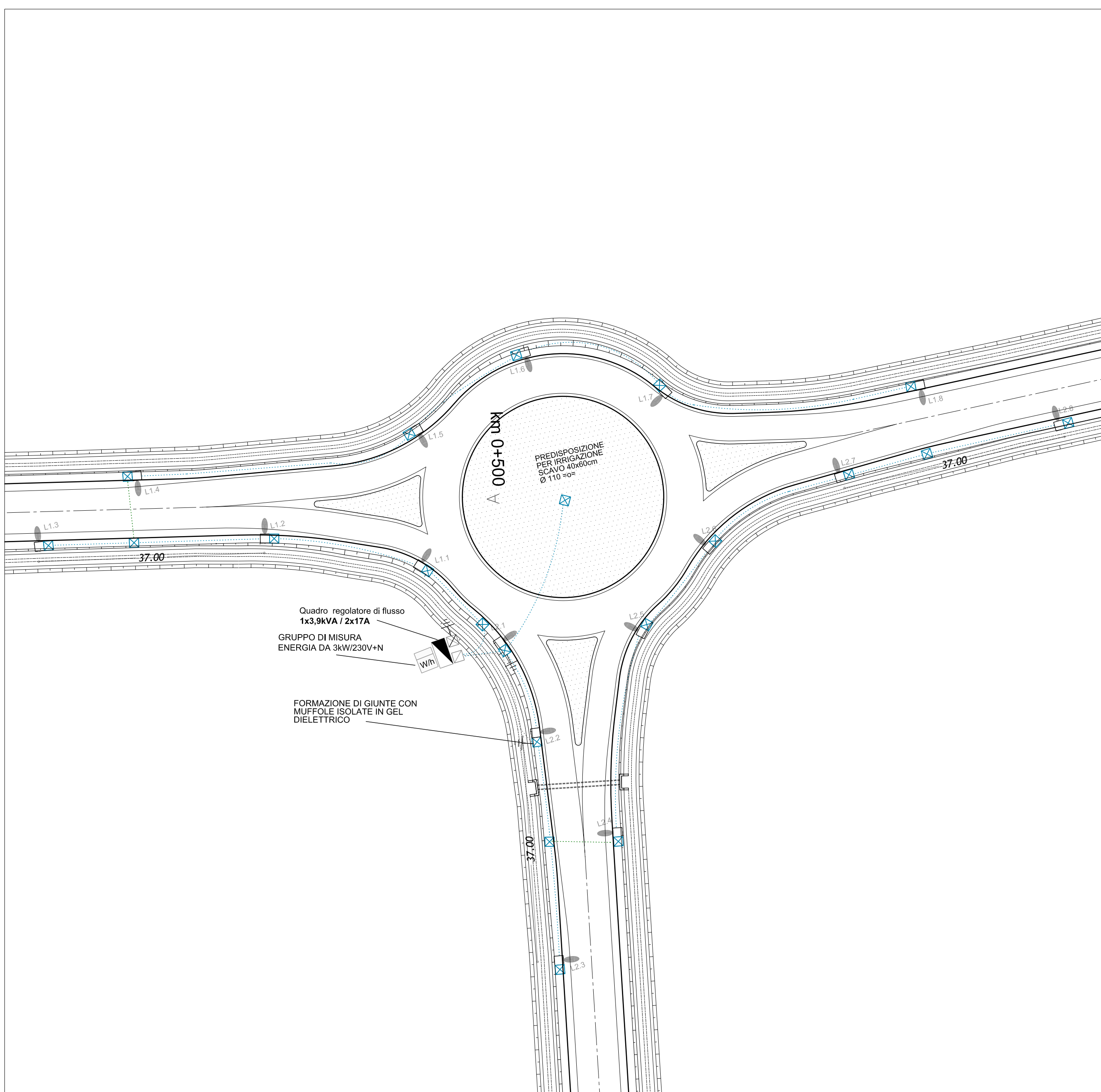
PLANIMETRIA CON DISTRIBUZIONE E TIPOLOGICHE IMPIANTI - ROTATORIA CO07-R3 - Scala: 1:500
