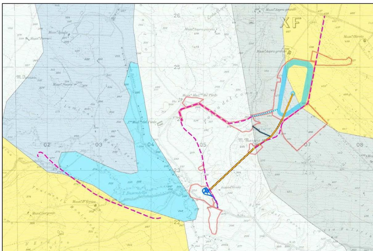
*Fig. 13 - Localizzazione delle opere in progetto in relazione alla Carta Geologica d'Italia su base IGM 1954. La linea gialla indica le vie d'acqua che saranno realizzate completamente in galleria.*
