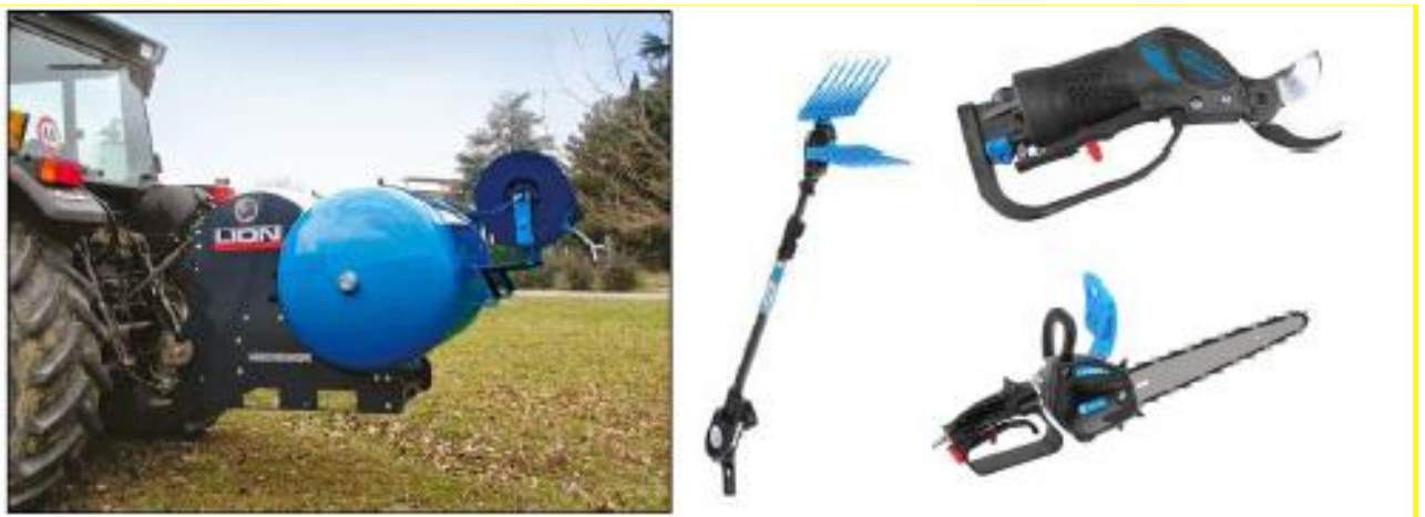
Compressore PTO per il funzionamento di strumenti pneumatici per l'arboricoltura
