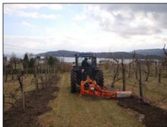
Esempio di fresatrice interceppo per le lavorazioni sulla fila
