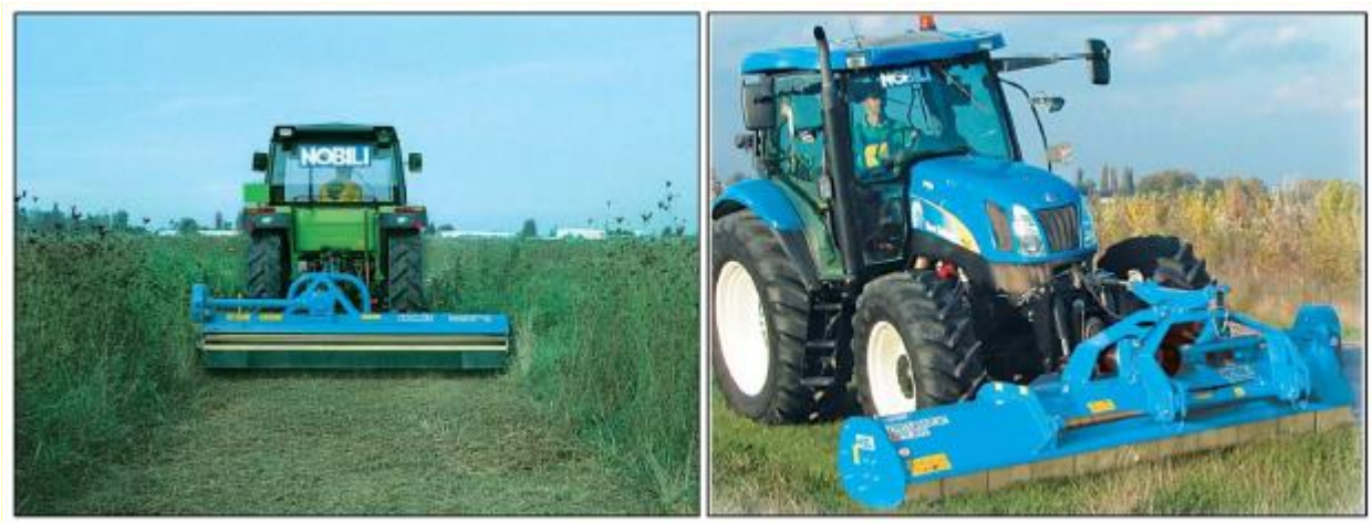
Esempi di trincia posteriore e anteriore di notevole larghezza
