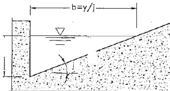
FIGURA 6.3.3-1 - SEZIONE TIPICA DI UNA BANCHINA LATERALE.
