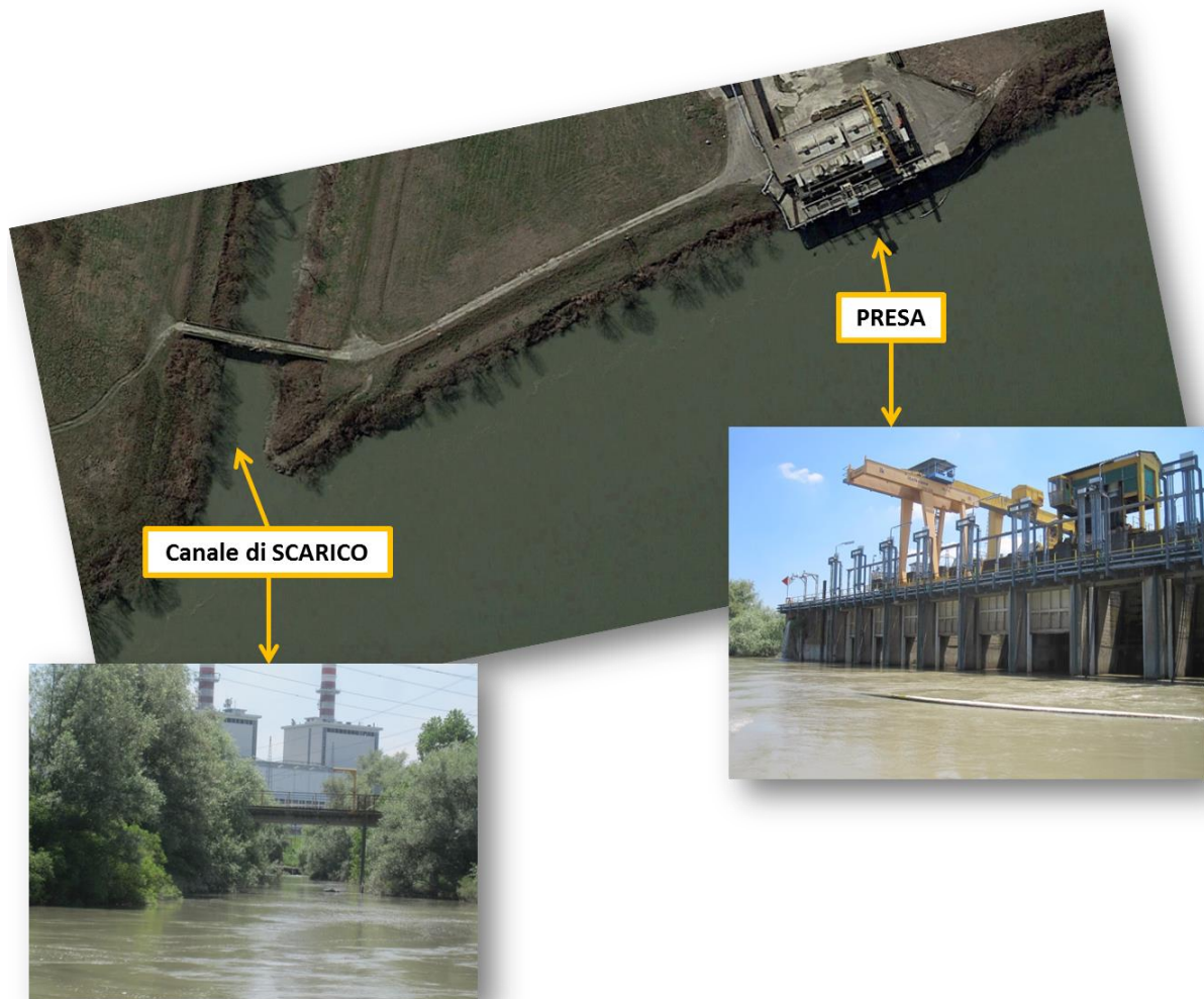
Figura 2 Localizzazione in sponda destra al fiume Po della presa e dello scarico delle acque di circolazione della centrale di La Casella (foto CESI giugno 2018).
