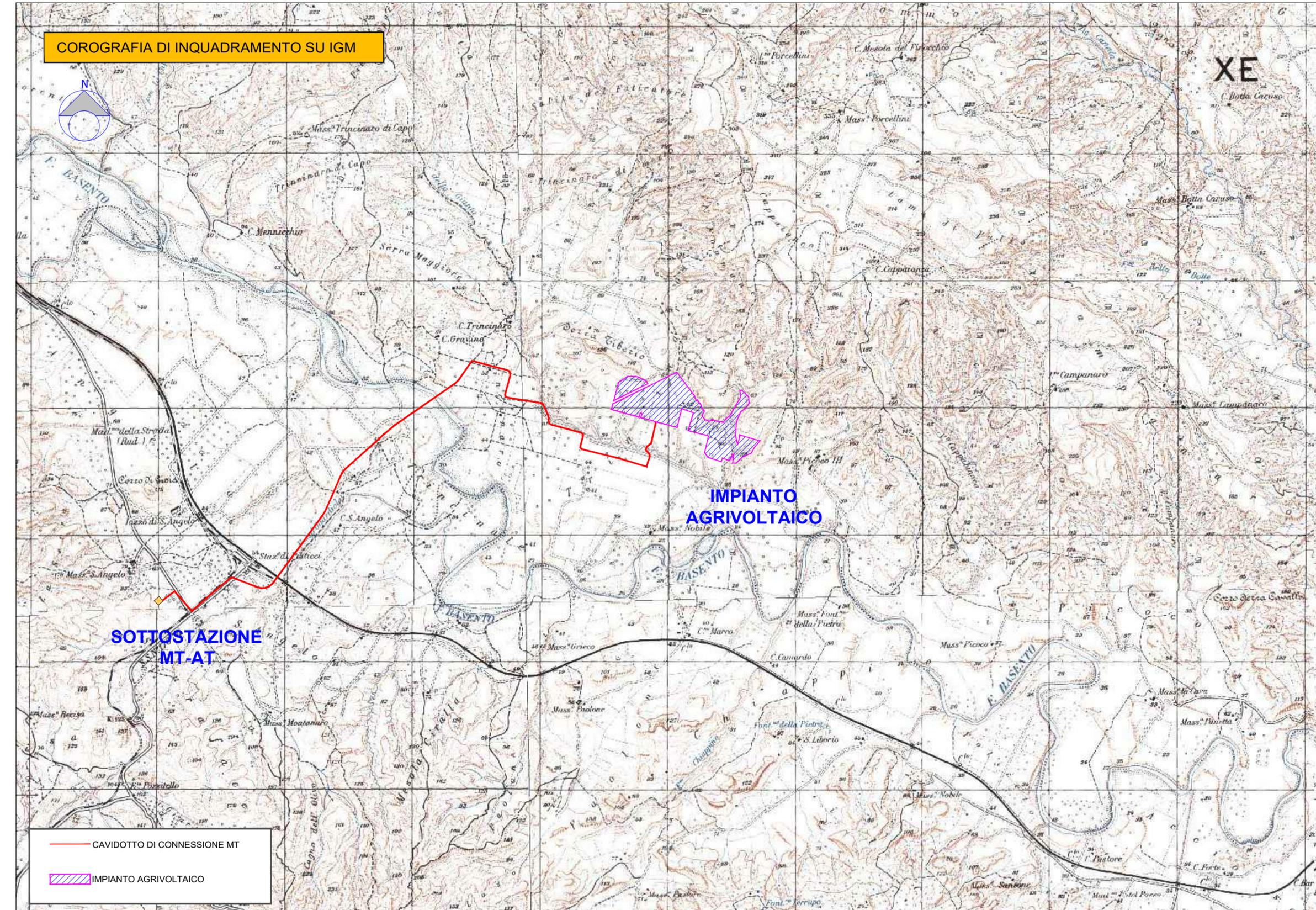
— CAVIDOTTO DI CONNESSIONE MT
