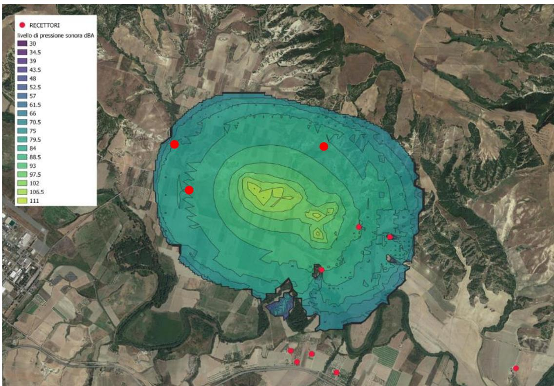
Figura 128 - Abstract del calcolo della diffusione della pressione sonora sulle aree limitrofe al cantiere in base ai dati di emissioni derivanti dalle macchine di cantiere (Fonte: ns elaborazione)
