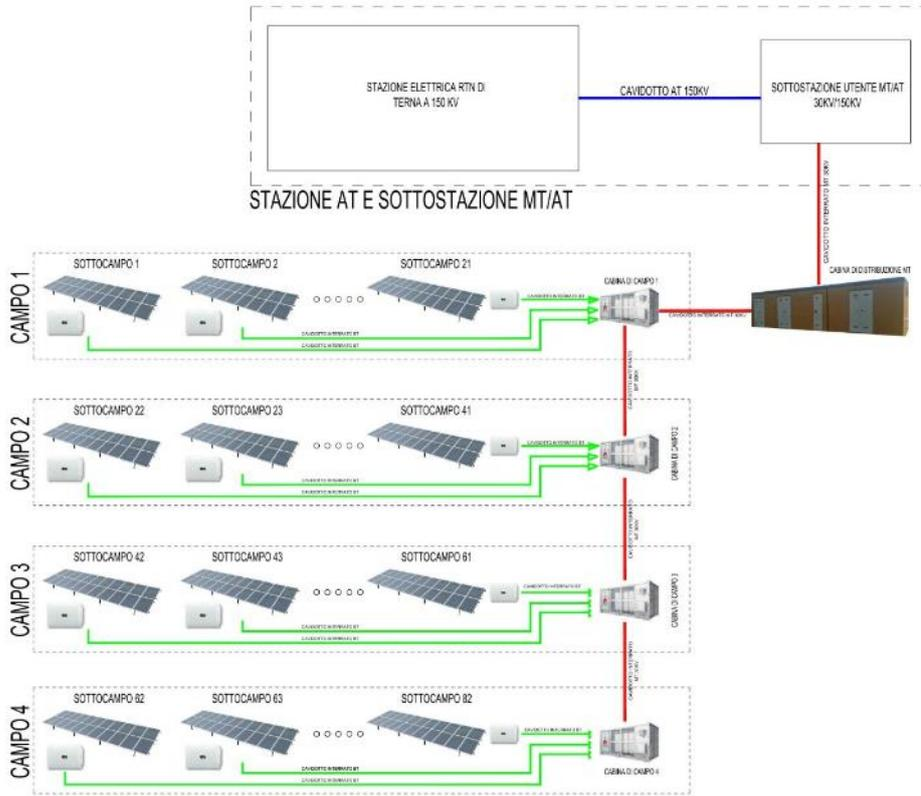
Figura 61 - Schema delle connessioni elettriche
