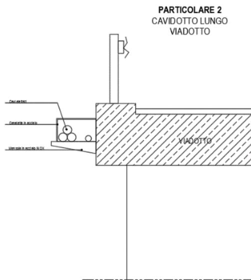
Figura 64 - Particolari risoluzione interferenze
