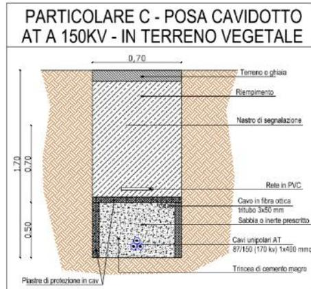
Figura 62 - Sezioni di scavo dei cavidotti
