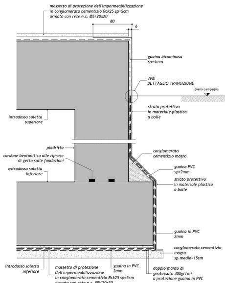
**DETTAGLIO IMPERMEABILIZZAZIONE SCATOLARE A CAVALLO DI FALDA**
