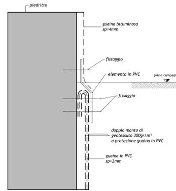
**DETTAGLIO TRANSIZIONE GUAINA PVC/BITUMINOSA**
