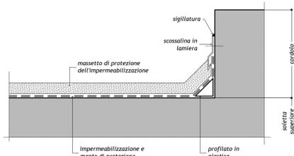
**DETTAGLIO IMPERMEABILIZZAZIONE ESTRADOSSO SCATOLARE**
