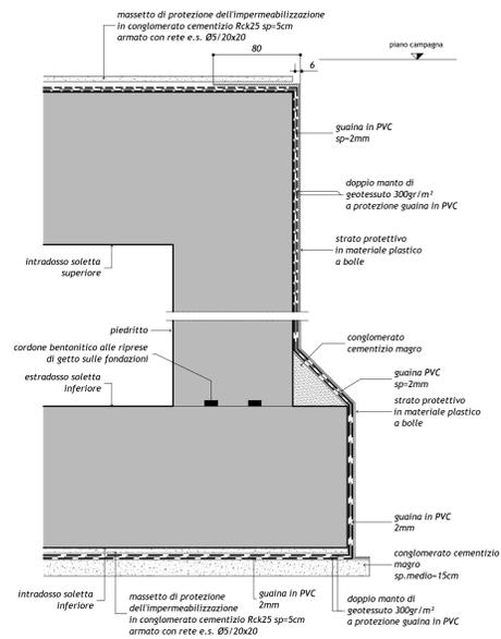
**DETTAGLIO IMPERMEABILIZZAZIONE SCATOLARE SOTTO FALDA**
