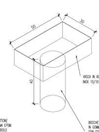
PARTICOLARE POZZETTO CAVIDOTTI
