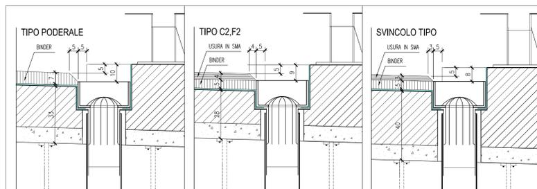
PIANTA PARTICOLARE SCARICO STANDARD
