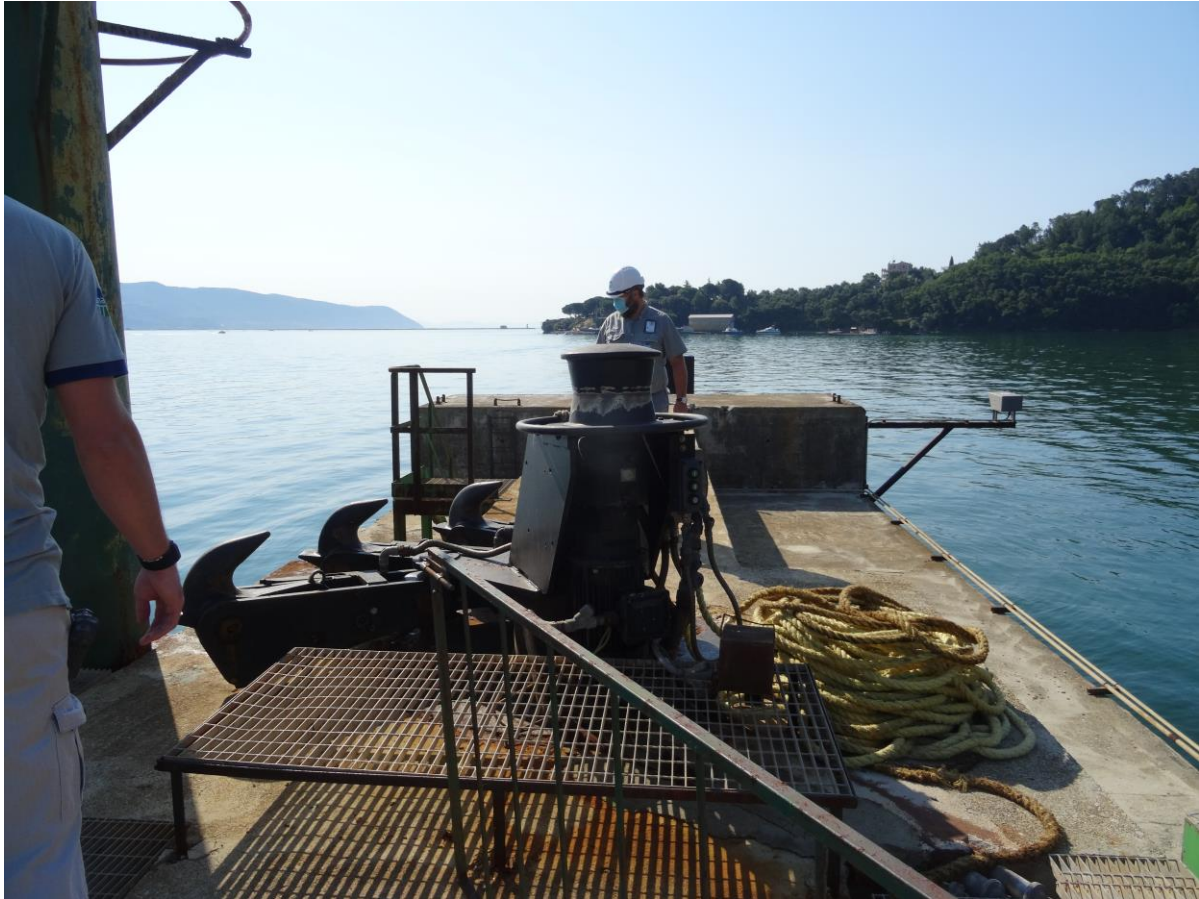
Foto 8: Dettaglio ganci a scocco
