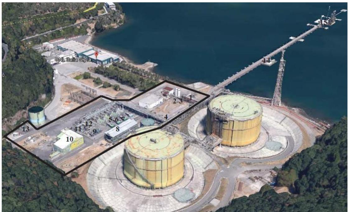
Figura 5 – Ortofoto 3D dell'impianto con indicazione delle principali sorgenti di rumore
