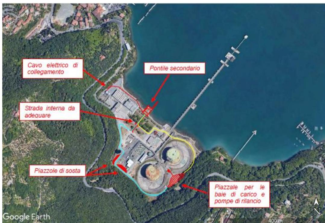
**Figura 6 – Stralcio planimetrico dell'impianto con individuazione delle aree di intervento – Truck Loading**
