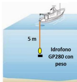
Figura 4-2: Schema del posizionamento del sensore acustico da imbarcazione appoggio
