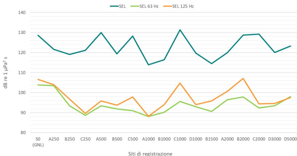
**Figura 5-1: Sound Exposure Level  $L_{E,p}$  (dB re  $1 \mu\text{Pa}^2 \text{ s}$ ) stimato nei diversi siti di registrazione**
