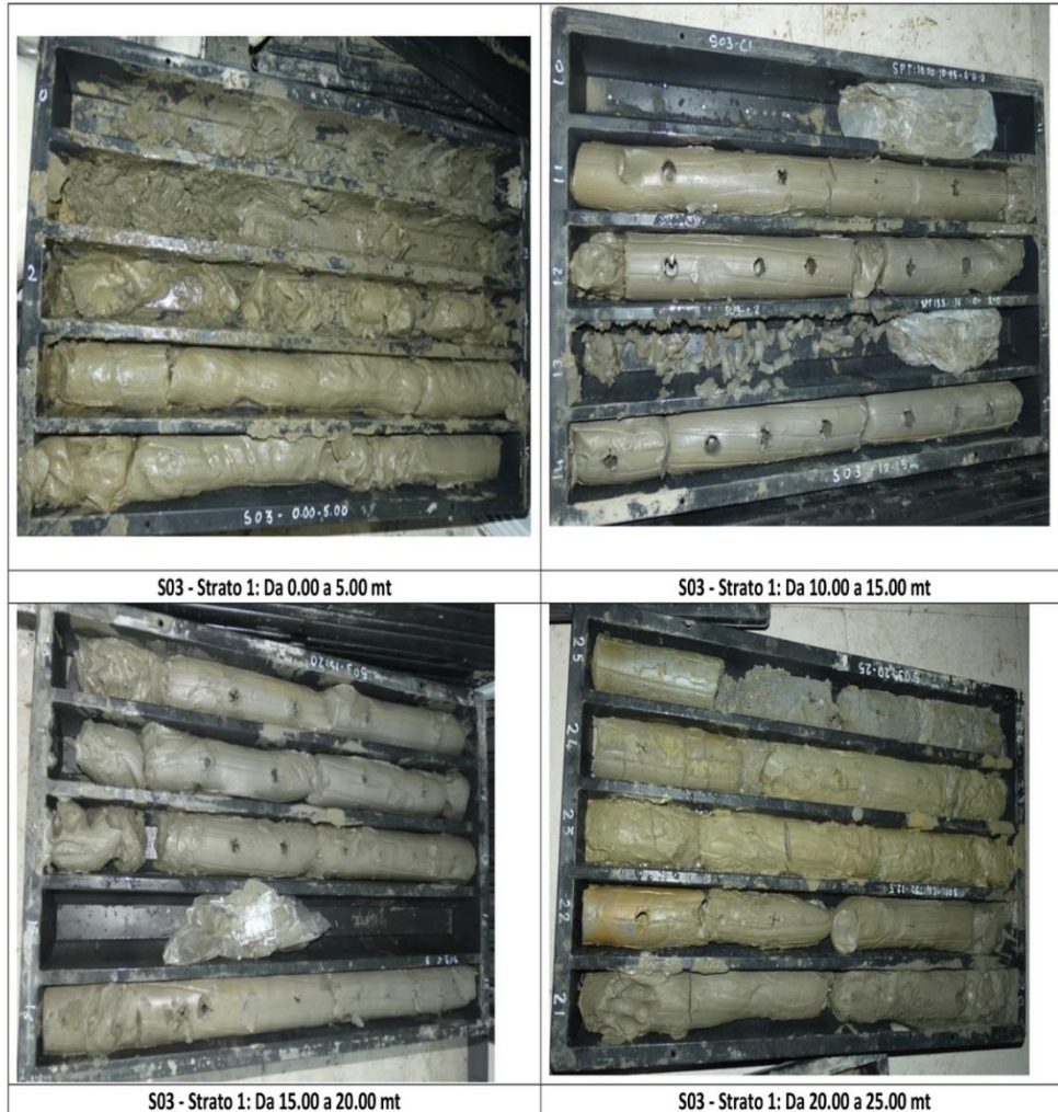
Figura 11: sondaggio S03 da 0.00 a 25.00 m
