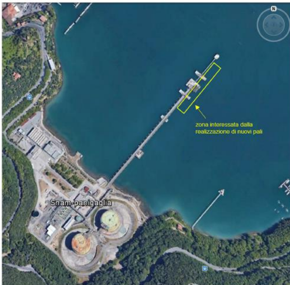
Figura 2/B: Terminale di Panigaglia: indicazione della zona destinata all'inserimento di nuove briccole
