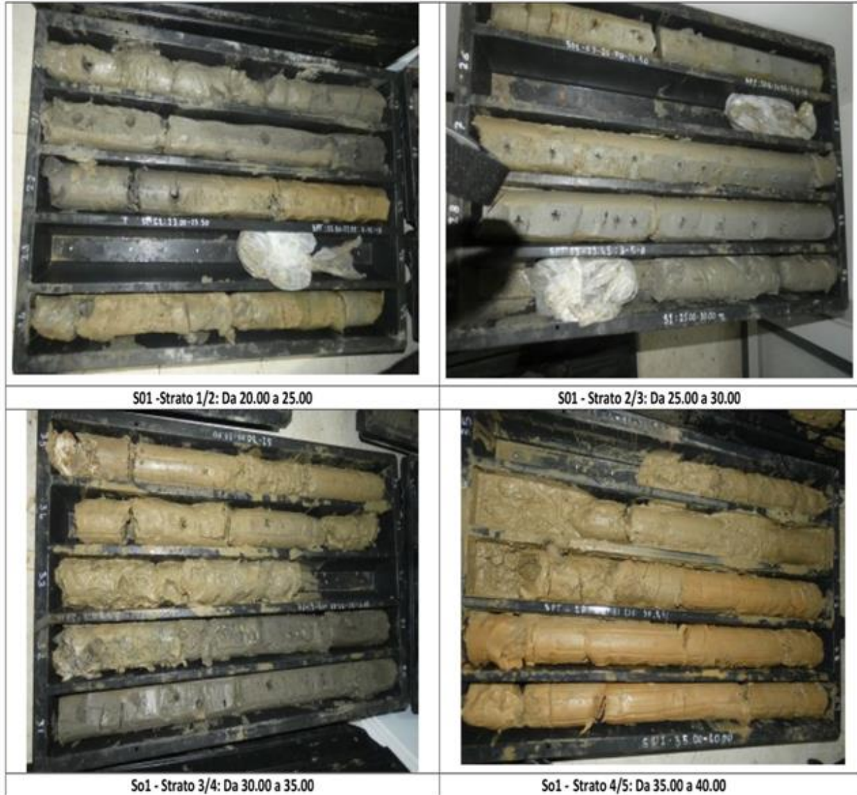
Figura 8: sondaggio S01 da 20.00 a 40.00 m
