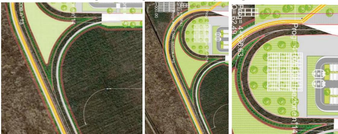
**Figura 6:** Stralcio planimetrico ramo di ingresso (a sinistra); stralcio planimetrico ramo di uscita (al centro) e stralcio planimetrico ramo di inversione (a destra) (Fonte: Allegati alla Lista di controllo)
