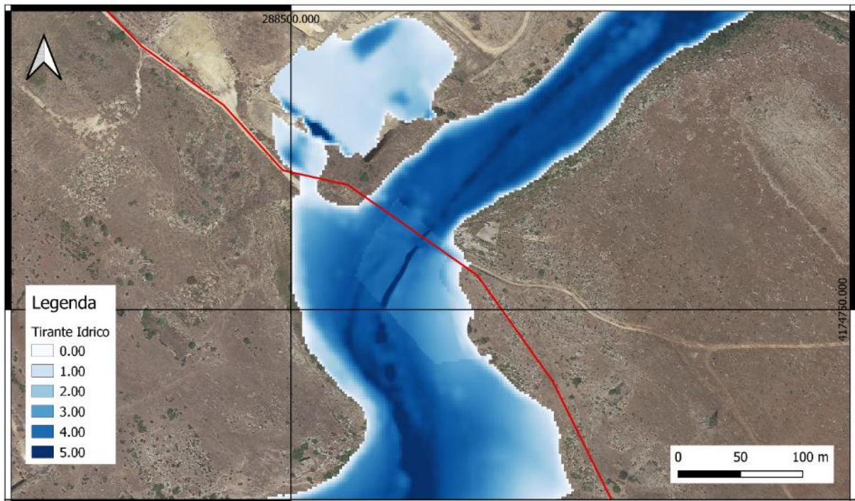
Figura 169 – Allagamento conseguente alla portata T300 del fiume Mazaro
