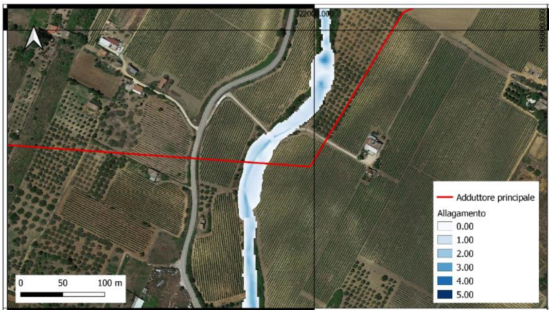
Figura 108 – Allagamento conseguente alla portata T200 del torrente Cavarretto
