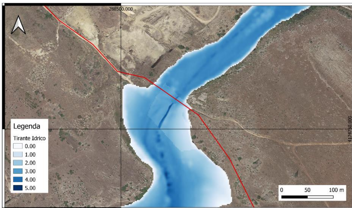
Figura 166 – Allagamento conseguente alla portata T50 del fiume Mazaro
