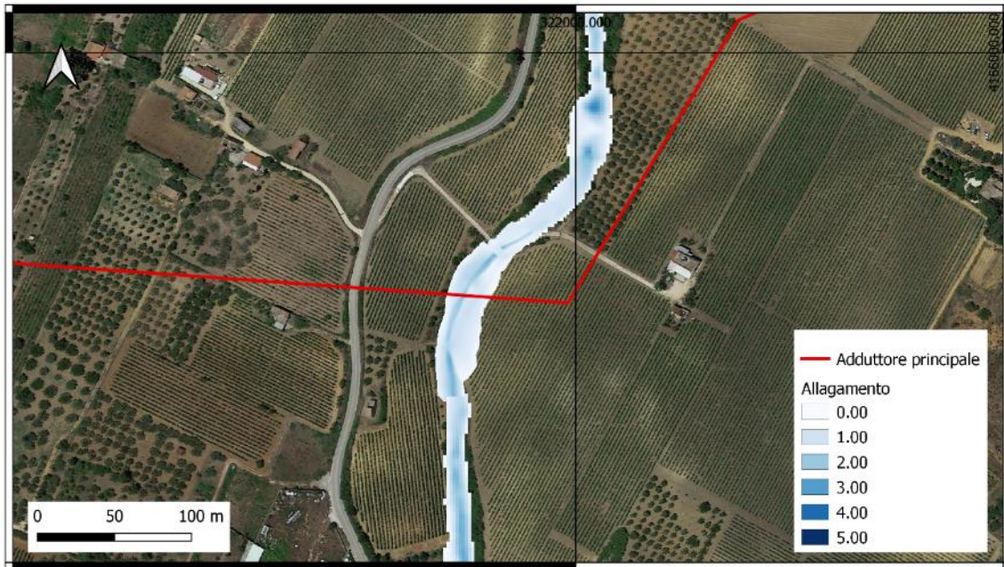
Figura 109 – Allagamento conseguente alla portata T300 del torrente Cavarretto
