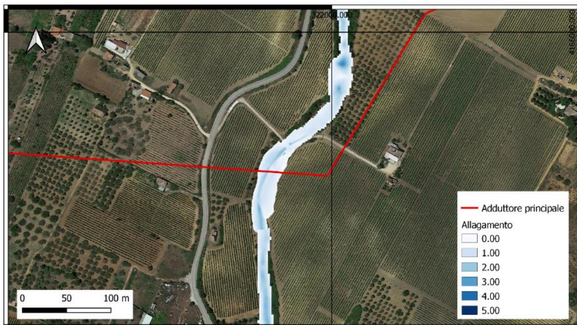
Figura 106 – Allagamento conseguente alla portata T50 del torrente Cavarretto
