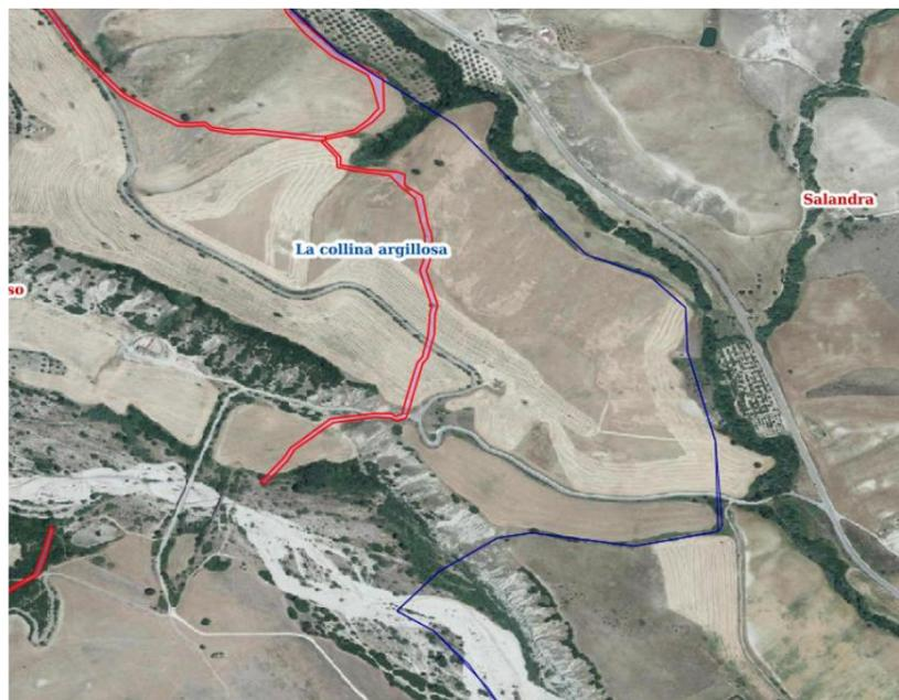
Figura 22: Punto di attraversamento del cavidotto esterno su strada interferente con il tratturo comunale "San Mauro Forte – Salandra - BCT\_189 nr 52 – MT"
