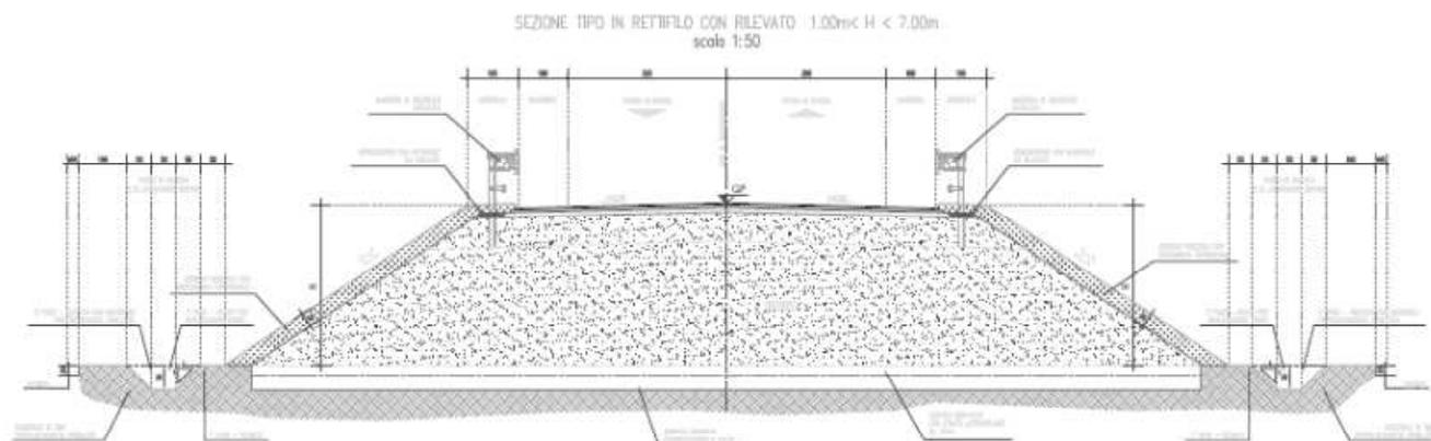
figura 1-3 - Sezione in rettilineo tipo F2
