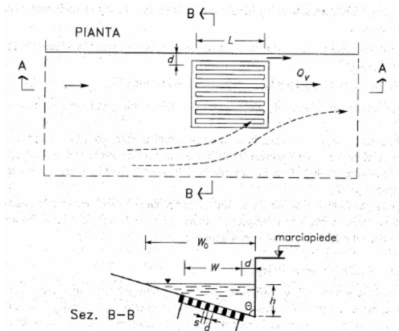
Figura 6.2 - Schema di calcolo per caditoie a salto di fondo (AA.VV, Sistemi di Fognatura, 1997)
