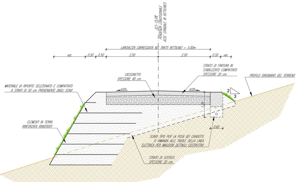
SEZIONE STRADALE TIPO: RILEVATO CON ELEMENTI IN TERRA RINFORZATA
