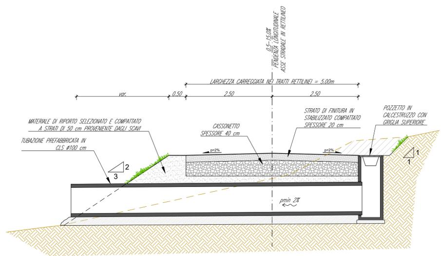
SEZIONE STRADALE TIPO: MEZZA COSTA CON ATTRAVERSAMENTO
