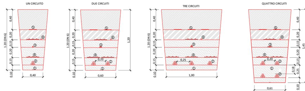
**CAVIDOTTO 150 kV IN TERRENO NORMALE
