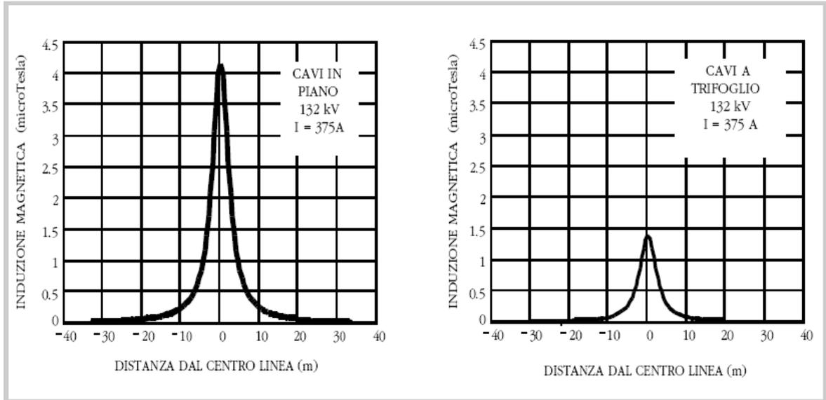
La possibilità di avere una induzione magnetica più bassa per la linea elettrica AT in cavo è dovuta alla vicinanza dei cavi stessi i quali, essendo isolati, possono essere accostati uno all'altro (cosa che non è possibile per una linea aerea). E' inoltre possibile ottenere un'ulteriore riduzione disponendo i cavi non allineati normalmente tra loro, ma a trifoglio.
