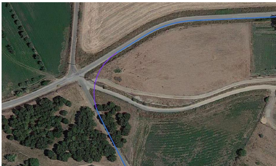
Figura 43 – Viabilità provvisoria di collegamento nella Strada Comunale Senorbì-Sisini.
