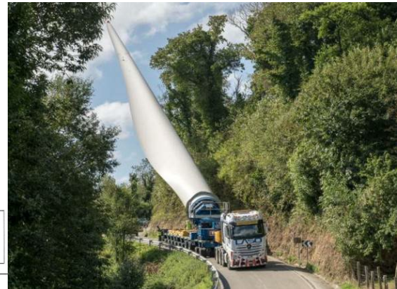
Figura 59 - Caratteristiche dimensionali dei mezzi di trasporto con trasbordo dei pezzi dell'aerogeneratore per la viabilità interna con blade lifter
