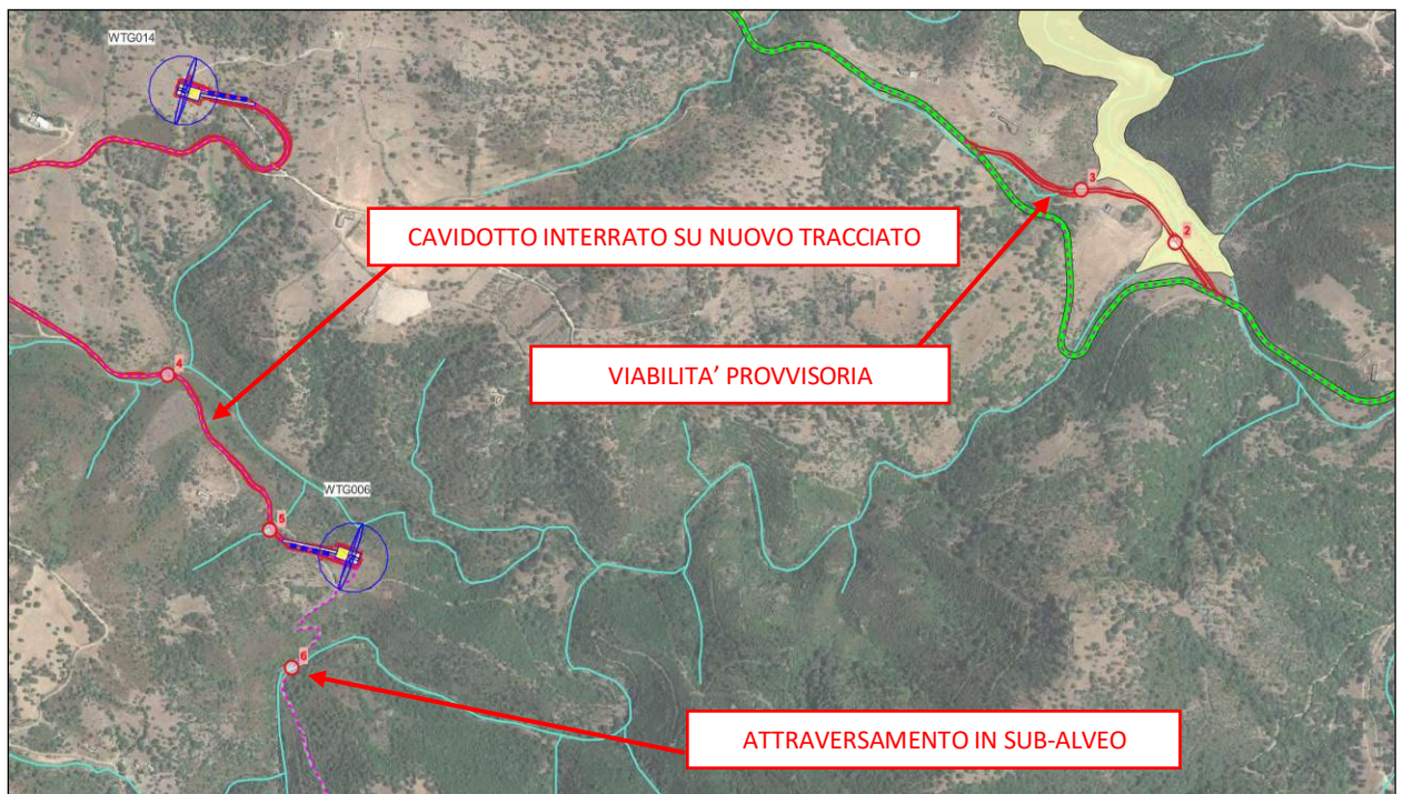
Figura 21 – Interferenze con il reticolo idrografico N. 02 – 03 su nuovo tracciato provvisorio per il trasporto delle componenti e N. 04 – 05 su tracciato permanente di collegamento alla piazzola e N. 06 sul tracciato cavidotto.
