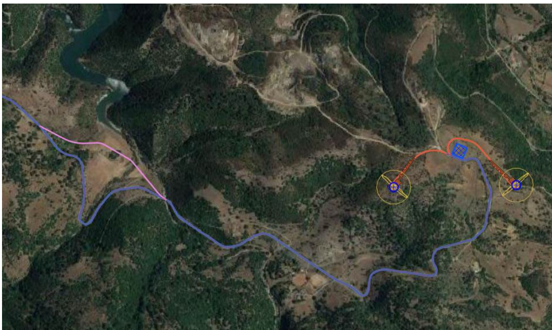
Figura 42 – Tratto temporaneo e slarghi sulla strada per il trasporto delle WTG011 e WTG012.
