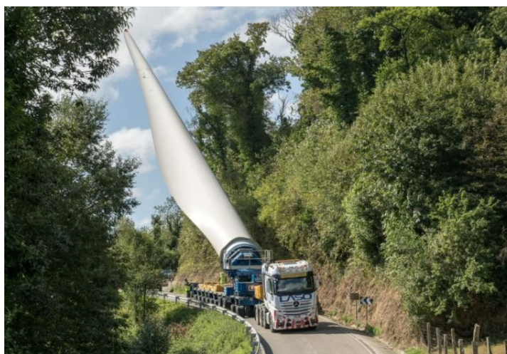
Figura 3 – Foto di trasporto lungo la viabilità interna tramite bladelifter per ridurre la lunghezza del rimorchio.
