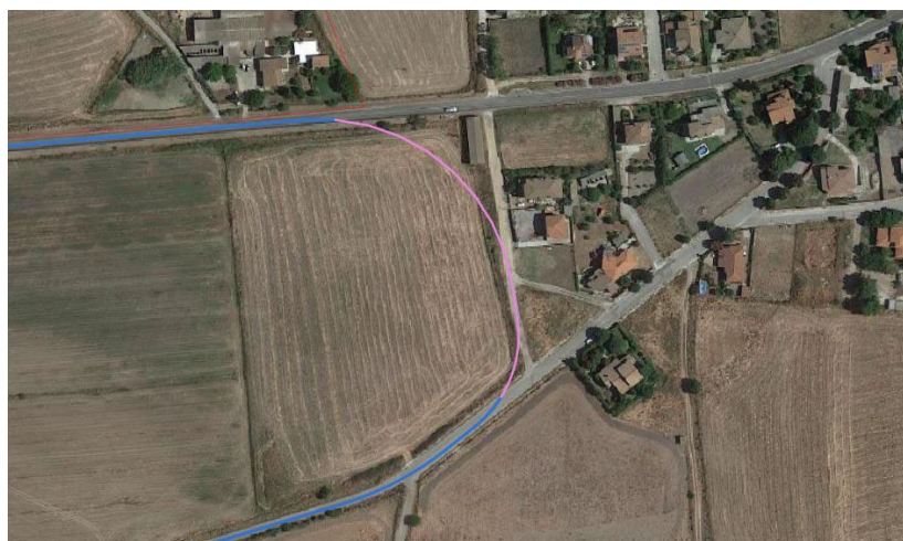
Figura 31 – Viabilità provvisoria di collegamento tra la S.P. 6 e la Strada Comunale Senorbi-Sisini.
