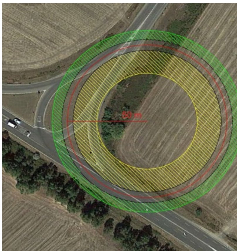
Figura 20 – Immagine per tratto di immissione dalla SP97 alla SP49 con angolo a 90°.
