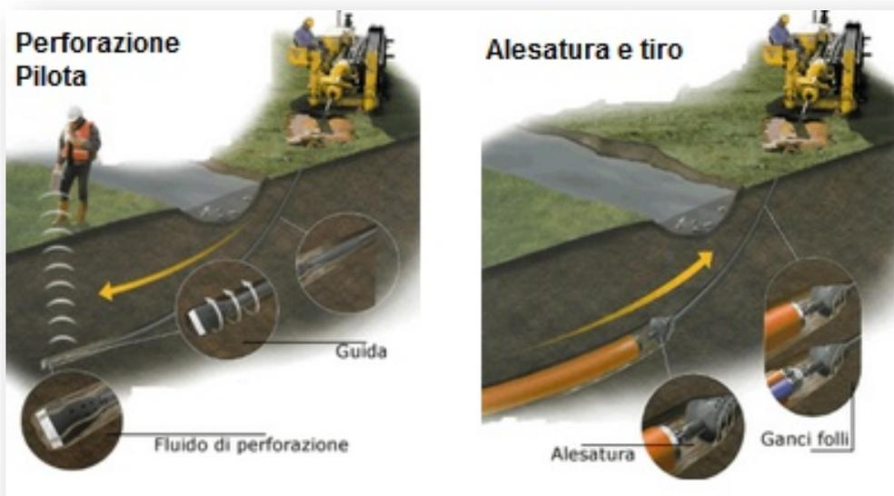
Figura 33 - tecnologia di trivellazione orizzontale controllata (TOC)
