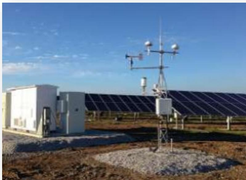
**Figura 31- Stazione meteorologica tipo**
