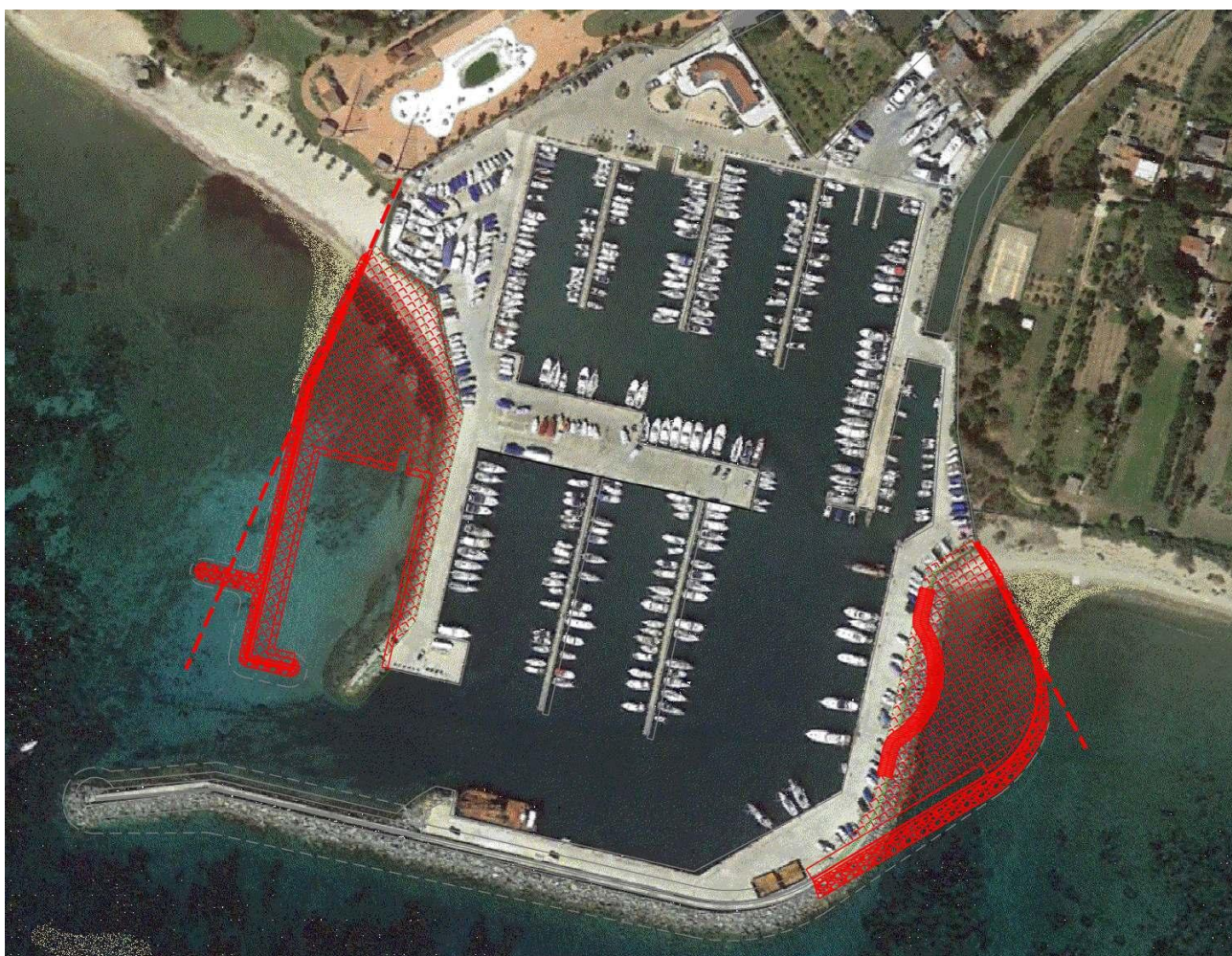
Fig.13 - Limiti di ingombro dell'ampliamento a est e a ovest (con la simulazione della disposizione delle spiagge al contorno)
