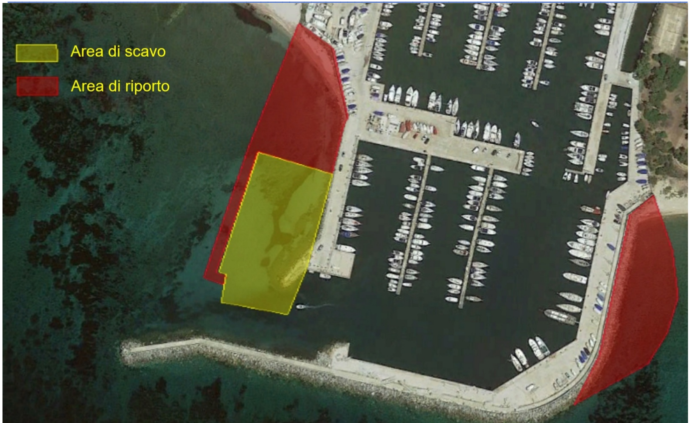
Fig.2 - Aree di scavo e di riporto
