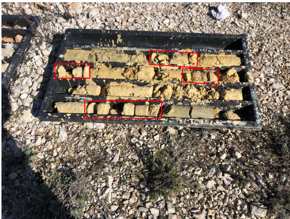
Fig. 8 – i livelli calcarenitici a “Panchina” del sondaggio S2, fronte mare NW, presentano in questo punto la maggiore continuità stratigrafica 30 – 40 cm del c.d. “livello geotecnico”, tra i 9.10 m e i 9.50 m.
