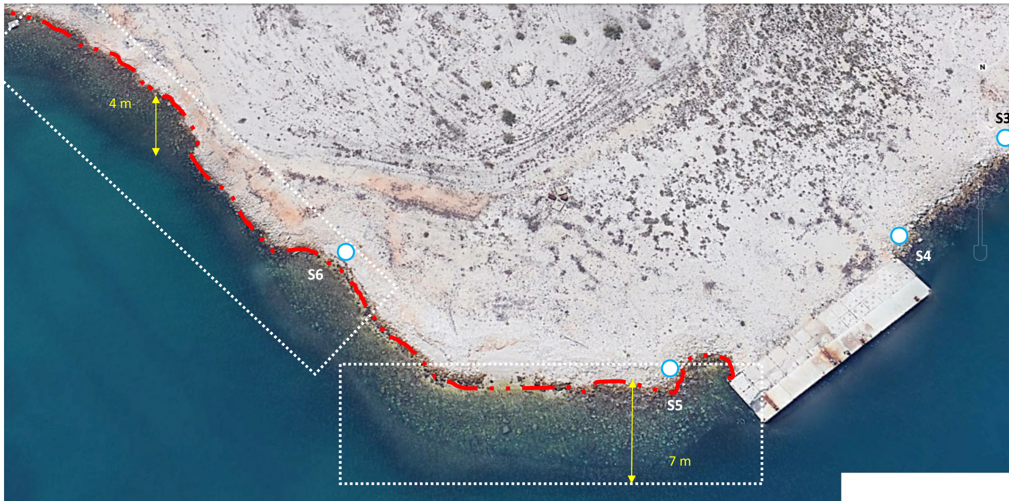
Fig. 33 - Colmata di “Capobianco” con l’evidenza dello spessore del prisma dei materiali inerti (calcarei e calcareo-dolomitici) di colmata, valutato in 6,5 m ÷ 7 m, con elevazione max s.l.m. di ca. 3.5÷4.0 m; primo tratto di banchinamento “a cassoni”, laddove il progetto di FTE valuterà l’opportunità di prosecuzione o di modifica della tipologia di intervento; il primo substrato di interesse geotecnico è definito da uno strato roccioso a “Panchina”, discontinuo latero-verticalmente individuato dalle indagini sismiche a rifrazione (MASW, 2021) e, dettagliato dai 6 (sei) sondaggi geognostici a carotaggio continuo (campagna di indagini 2022).
