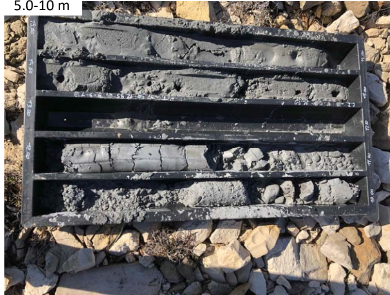
Fig. 11-14 : il sondaggio S4 ha attraversato dai 7.0 ai 10 m ca. una serie di livelli ciottolosi ed a "Panchina"; ai 15.5 ai 17.5 m seguono i depositi torbosi di un paleocanale, con l'intervallo a maggiore % in sostanza organica. Per i parametri geotecnici si rimanda ai certificati di analisi S4-C1; S4-C2; S4-C3; S4- C4; S4 - C5;
