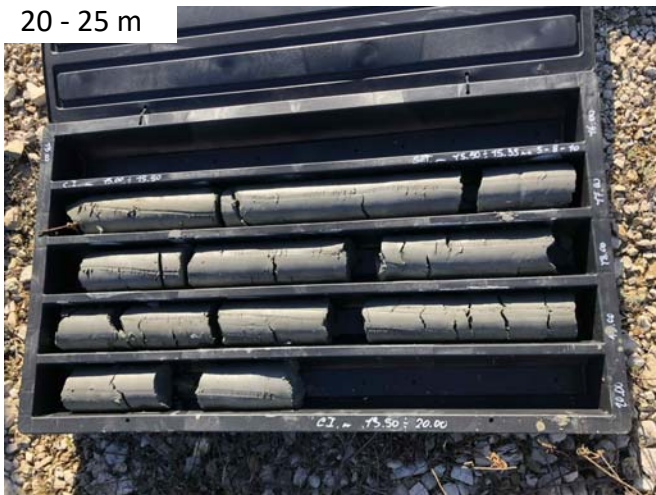
Fig. 15-19 – Sondaggio S1: sequenza stratigrafica completa; attraversamento dei materiali lapidei di colmata calcarei-dolomitici (tout venant, massi 1 a e 2 a cat.?), segue un sottile livello di sabbie incoerenti di spiaggia sommersa (0.0 – 5.0m), sabbie giallastre e livelli di Panchina decimetrici (5.0 – 10m), passaggio a limi sabbiosi grigi (10-15m), chiudono le argille limose grigio-azzurre (25-30m)
