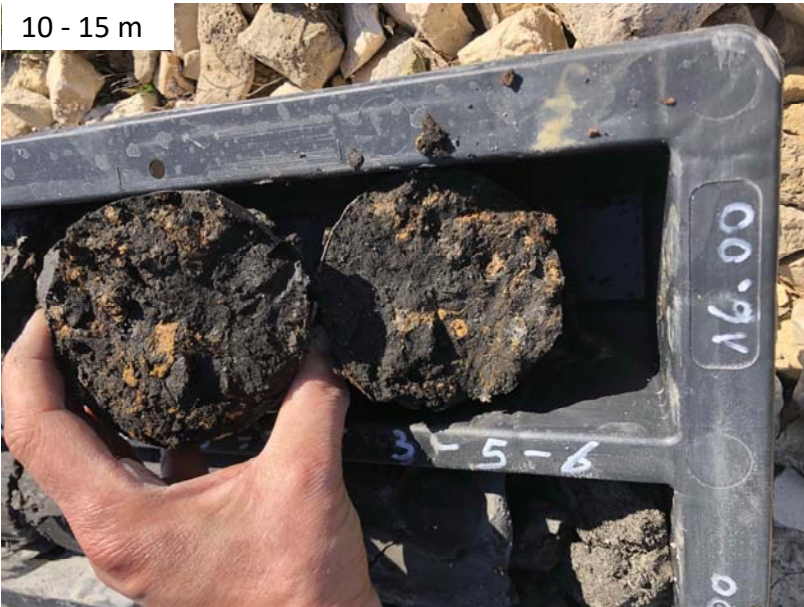
Fig. 11-14 : il sondaggio S4 ha attraversato dai 7.0 ai 10 m ca. una serie di livelli ciottolosi ed a "Panchina"; ai 15.5 ai 17.5 m seguono i depositi torbosi di un paleocanale, con l'intervallo a maggiore % in sostanza organica. Per i parametri geotecnici si rimanda ai certificati di analisi S4-C1; S4-C2; S4-C3; S4- C4; S4 - C5;
