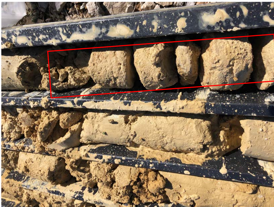
Fig. 9 – S2: dettaglio del c.d. "livello geotecnico", tra i 9.10 m e i 9.40 m, livello calcarenitico a "Panchina" sul quale sono state eseguite le prove geotecniche di laboratorio PLT - point load test
