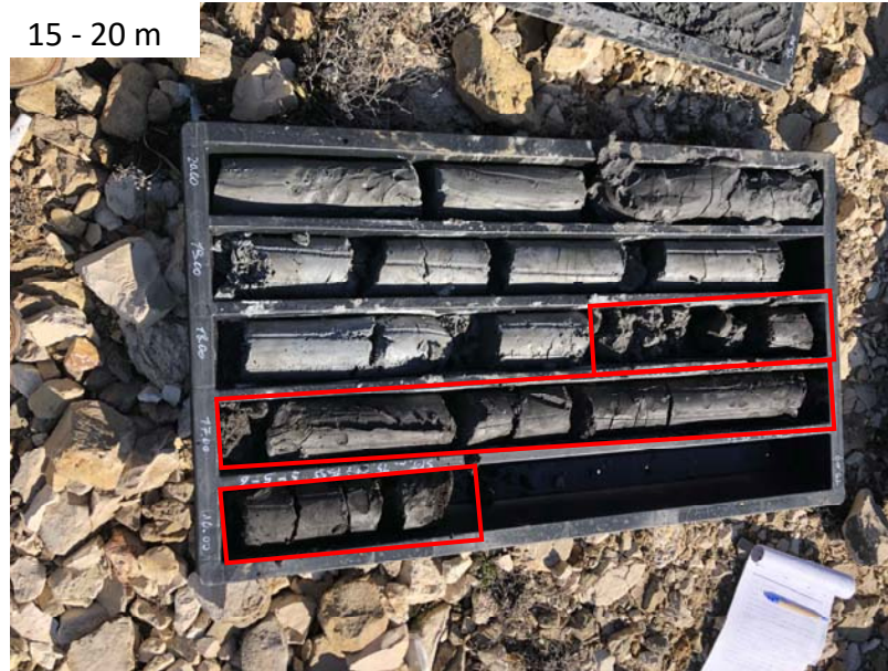
Fig. 11-14 : il sondaggio S4 ha attraversato dai 7.0 ai 10 m ca. una serie di livelli ciottolosi ed a "Panchina"; ai 15.5 ai 17.5 m seguono i depositi torbosi di un paleocanale, con l'intervallo a maggiore % in sostanza organica. Per i parametri geotecnici si rimanda ai certificati di analisi S4-C1; S4-C2; S4-C3; S4- C4; S4 - C5;
