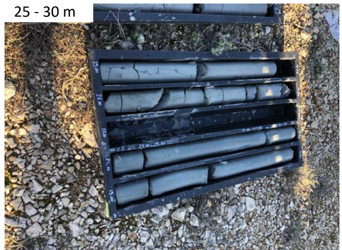
Fig. 15-19 – Sondaggio S1: sequenza stratigrafica completa; attraversamento dei materiali lapidei di colmata calcarei-dolomitici (tout venant, massi 1 a e 2 a cat.?), segue un sottile livello di sabbie incoerenti di spiaggia sommersa (0.0 – 5.0m), sabbie giallastre e livelli di Panchina decimetrici (5.0 – 10m), passaggio a limi sabbiosi grigi (10-15m), chiudono le argille limose grigio-azzurre (25-30m)
