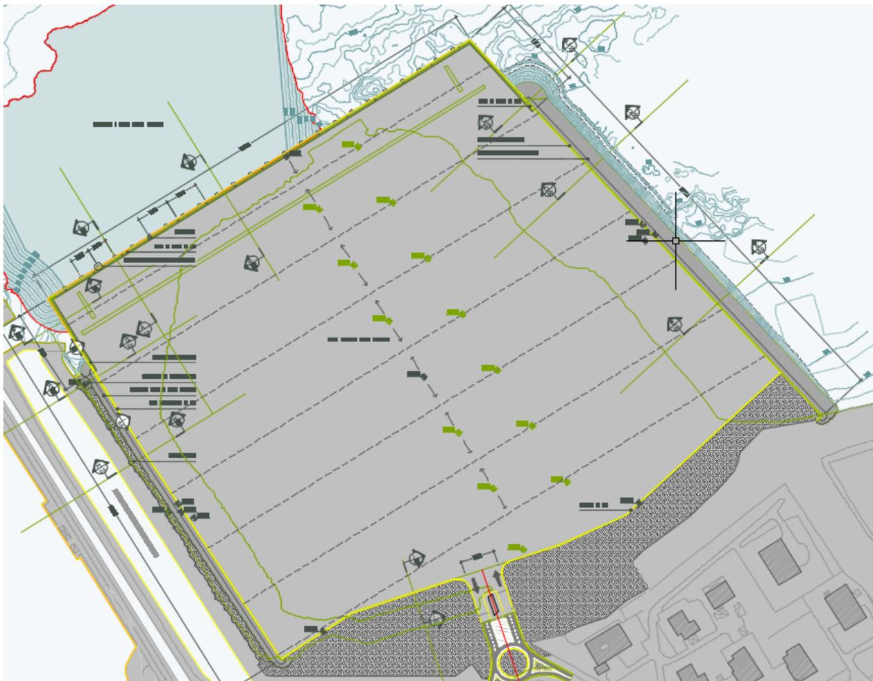
Il piazzale ha quota di + 3,50 m s.l.m.; al fine di facilitare il convogliamento delle acque di pioggia verso le caditoie lineari sono state definite delle linee di colmo parallele alla banchina di riva con quota +3,50
