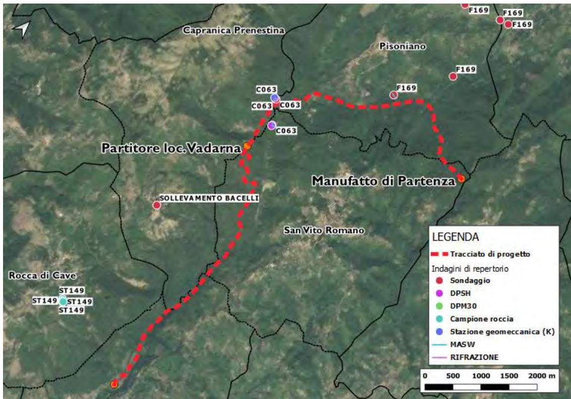
Figura 8.3. Ubicazione delle indagini geognostiche e geofisiche di repertorio del tratto T1. Il tracciato di progetto T1 è evidenziato in rosso.
