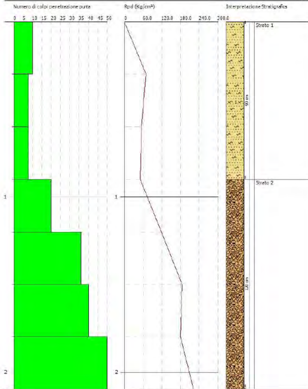
Figura 8.7. Risultati della prova penetrometrica DPSH2.
