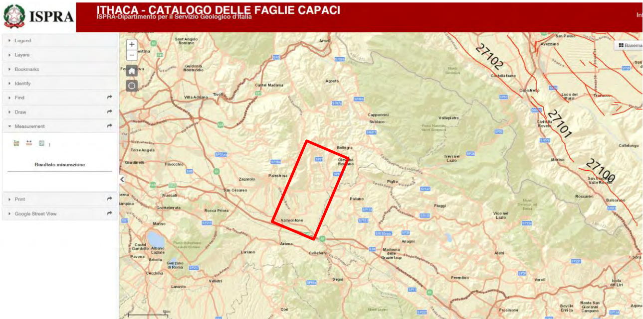
Figura 7.2. Localizzazione e codice identificativo delle Faglie Capaci prossime all'area di progetto, come rappresentate nel Catalogo ITHACA ( http://www.isprambiente.gov.it/it/progetti/ suolo-e-territorio-1/ithaca-catalogo-delle-faglie-capaci ).
