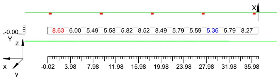
**4.6 Valori delle Luminanze su: Sottopasso wall0 1 1 (x=-60.00;y=2.83;z=1.50)m ---> (x=30.00;y=2.83;z=1.50)m**
