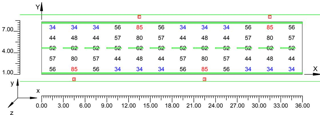
**4.4 Valori delle Luminanze su: Sottopasso wall1 1 1 (x=-60.00;y=2.83;z=1.50)m ---> (x=30.00;y=2.83;z=1.50)m**
