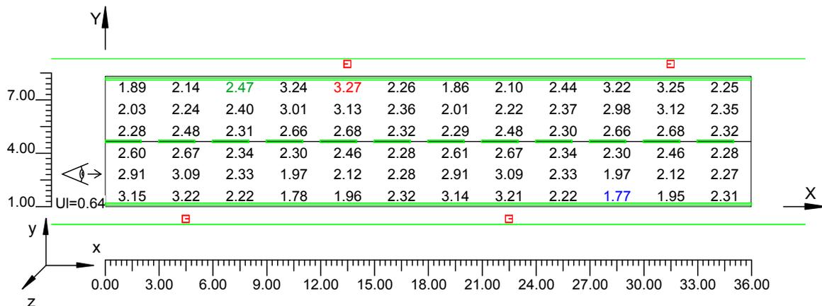
**4.2 Valori delle Luminanze su: Carregg A 1 Oss. 2(x=96.00;y=6.48;z=1.50)m**
