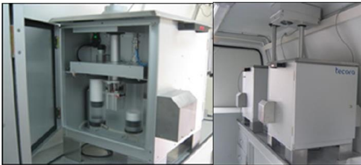
Figura 2-23 – Dettaglio campionatori sequenziali.
