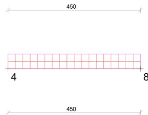
ARMATURA DI BASE SUP.=INF. SETTO 10 QUOTA m.1.00- 1.50
