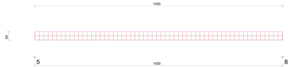
ARMATURA DI BASE SUP.=INF. SETTO 9 QUOTA m.0.00- 1.50
