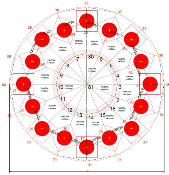
Figura 2 - Tipico della fondazione delle WTG (D\_3.15\_FONDAZWTG)
