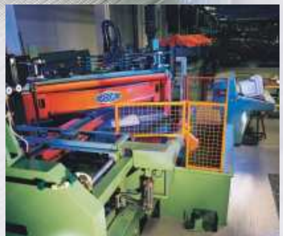
Impianto di taglio del lamierini
