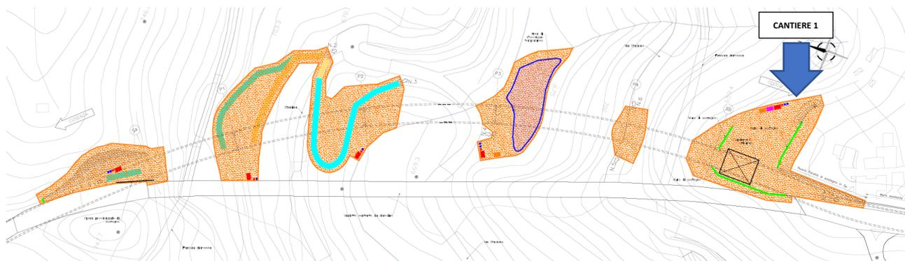
Figura 40 – Estratto elaborato V382033000APA "Planimetria aree di cantiere e viabilità di servizio"
