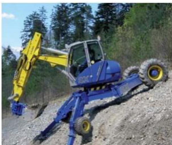
Figura 39 – Escavatore del tipo Ragno
