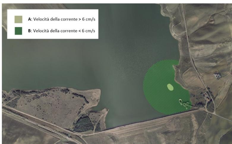
**Figura 1. Localizzazione delle zone di alterazione del campo di moto indotte dall'esercizio del nuovo impianto a pompaggio all'interno dell'invaso di Serra del Corvo.**
