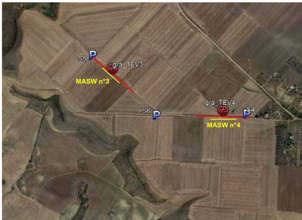
Figura 37. Gravina in Puglia. Area del bacino di monte. Ubicazione dei sondaggi S4 – S5 – S6, delle TEV n°3 e TEV n°4 e delle MASW n°1 e MASW n°2.
