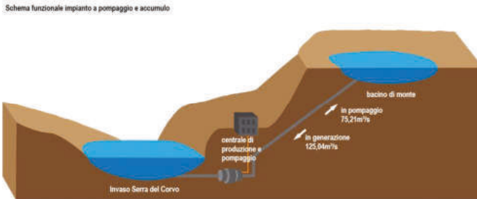
Figura 2. Schema funzionale illustrativo dell'impianto a pompaggio in progetto.
