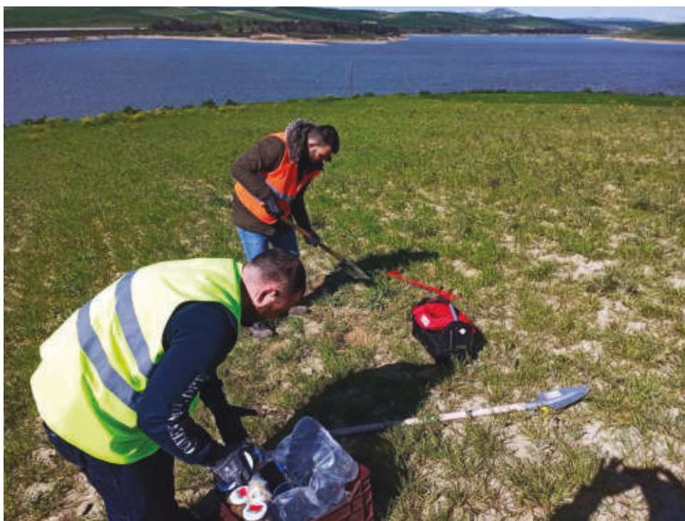
Figura 13. Gravina in Puglia – Diga di Serro del Corvo. Prelievi di campioni ambientali per la definizione preliminare del PGTRS curati dai tecnici di Artea S.r.l..
