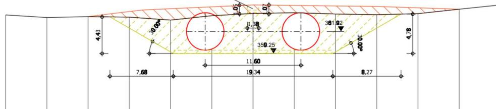
**Figura 4. Sezione tipologica indicativa delle modalità di posa delle condotte forzate (estratto Tavola PD-EP.17.4.2).**
