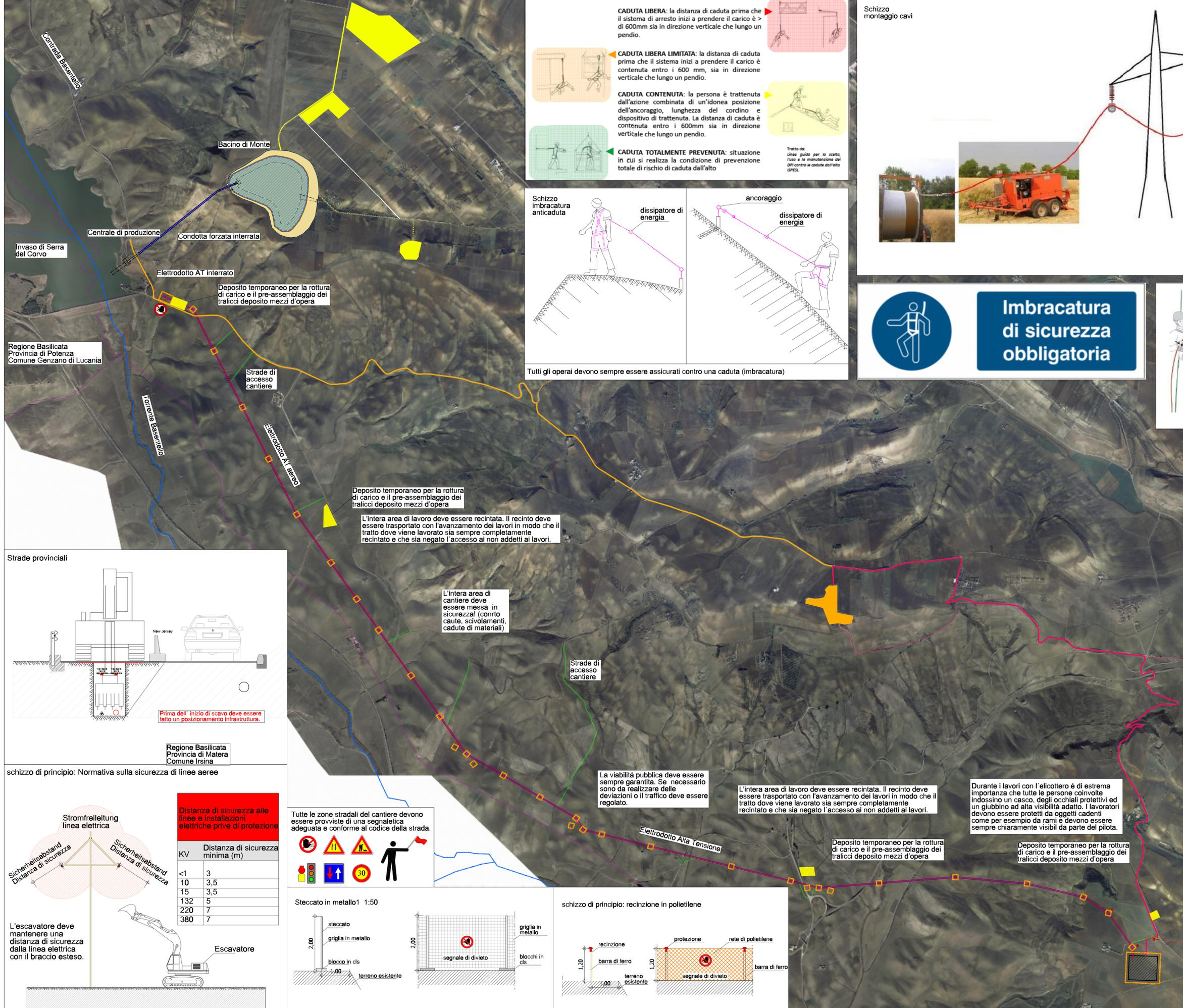
**CADUTA LIBERA:** la distanza di caduta prima che il sistema di arresto inizi a prendere il carico è > di 600mm sia in direzione verticale che lungo un pendio.
