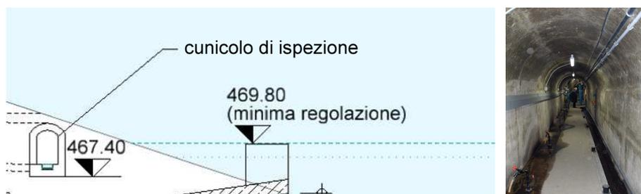
**Figura 74.** Cunicolo di ispezione previsto nel progetto. Si rimanda alla tavola PD-EP.16.3.
