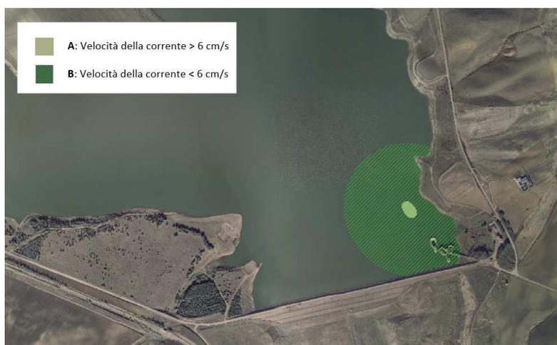
**Figura 187. Localizzazione delle zone di alterazione del campo di moto indotte dall'esercizio del nuovo impianto a pompaggio all'interno dell'invaso di Serra del Corvo.**
