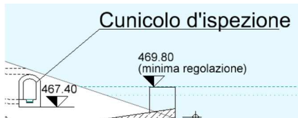
Figura 9. Cunicolo di ispezione previsto nel progetto. Si rimanda alla tavola PD-EP.16.3.
